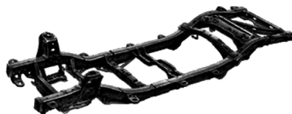
图 1-15 雪佛兰开拓者汽车的梯形车架
